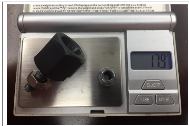
Figura 12: Quinta aferição, conjunto parcialmente montado: 17,9 g
