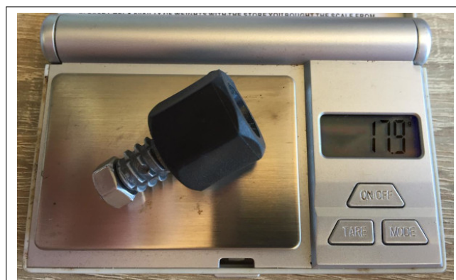
Figura 6: Massa de um conjunto de parafuso e porcas
