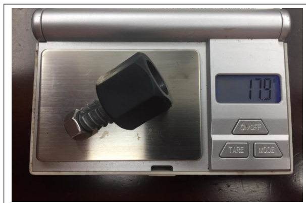
Figura 9: Segunda aferição, conjunto montado em outra posição: 17,9 g
