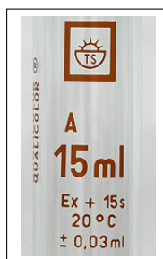
Figura 7: Pipeta com erro de \pm 0,03 ml.
