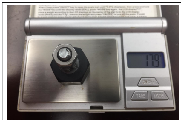
Figura 10: Terceira aferição, conjunto montado em pé: 17,9 g
