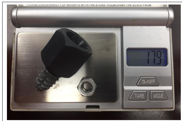
Figura 13: Sexta aferição, conjunto parcialmente montado de outro jeito: 17,9 g
