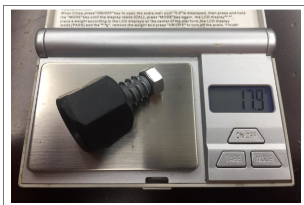
Figura 8: Primeira aferição, conjunto montado: 17,9 g
