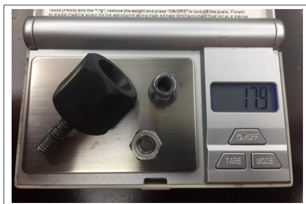
Figura 11: Quarta aferição, conjunto desmontado: 17,9 g
