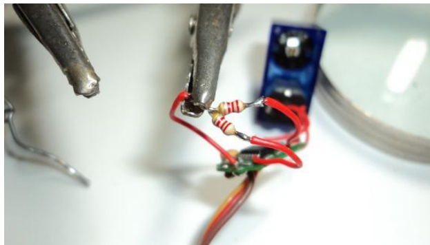
Figura 90: soldagem dos resistores nos fios
