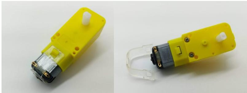
Agora pegue 2 fios, solde ao motor e faça um acabamento colocando um pouco de cola quente, para evitar qualquer tipo de curto-circuito ou contato indesejado.
