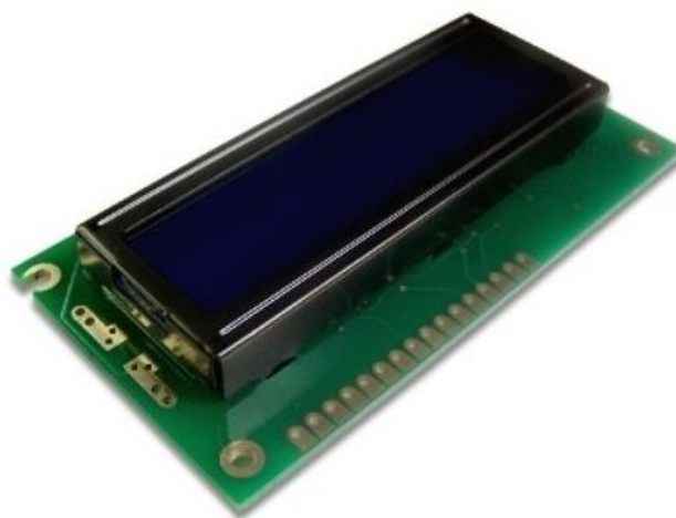
LCD 16x2. Créditos: Eletrogate
