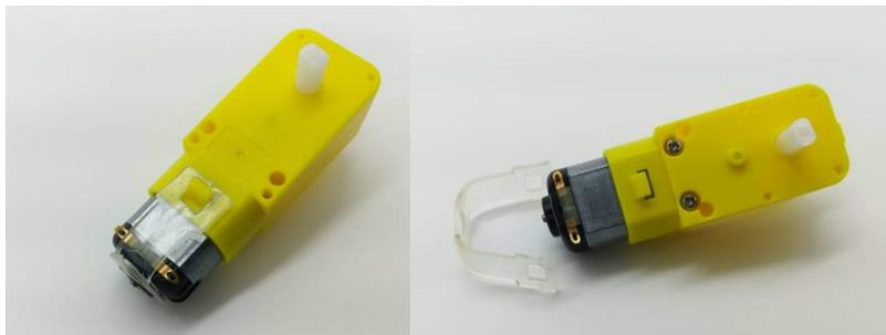
Após isso, retire-o e faça a ligação de fios aos terminais do motor com solda, e também é recomendado passar um pouco de cola quente em cima da solda para evitar algum curto ou contato indesejado.
