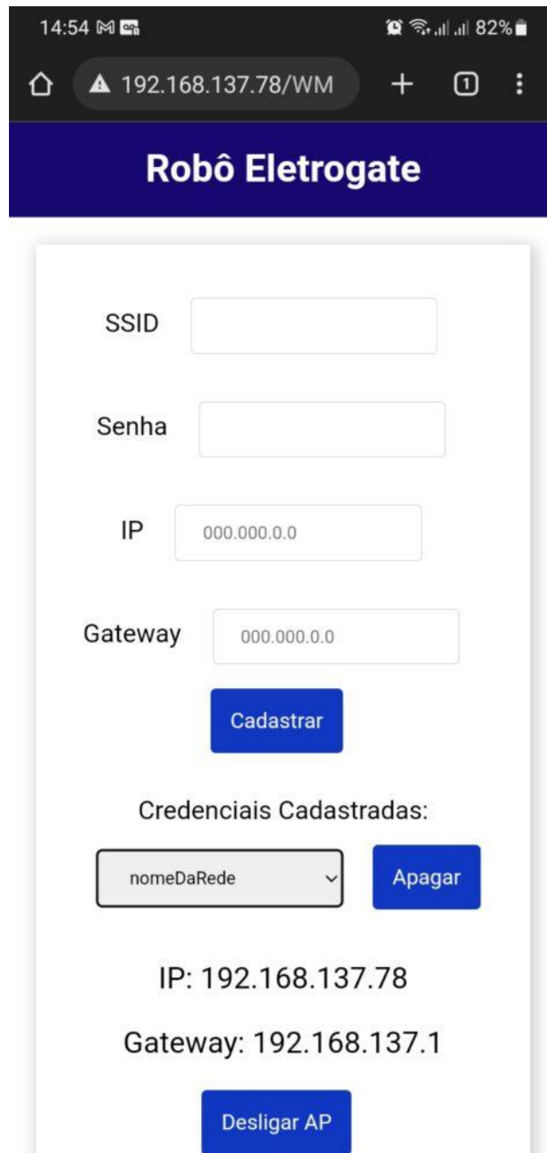
Figura 55: Gerenciador de wifi exibindo o IP atribuído ao robô pela rede e seu respectivo gateway, acessada pela rede cadastrada
