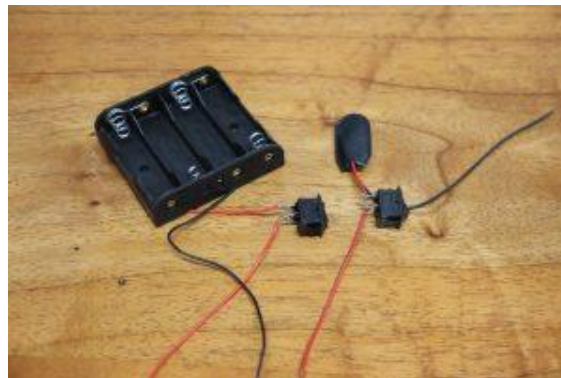
Figura 26: Adaptador e suporte com chaves soldadas
