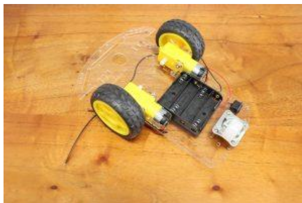
Figura 27: Suporte para pilhas colado na parte inferior do chassi
