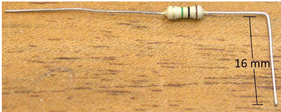
Figura 39: Tamanho da parte do terminal a ser utilizada
