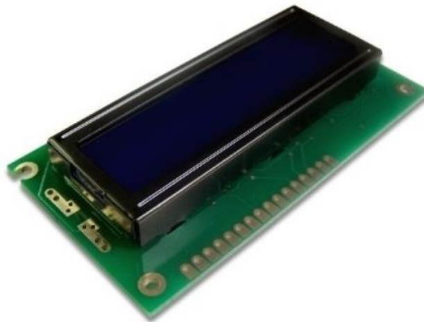
LCD 16x2. Créditos: Eletrogate
