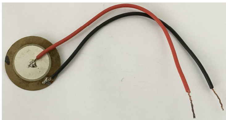
Figura 10.4: PZT com fios conectando seus terminais.
